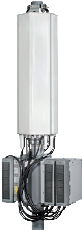
Hochleistungs-Basisstation mit 6 Sektorenantennen, die sowohl im LTE- als auch im UMTS- und/oder im GSM-Modus mit bis zu 6 GSM-Kanälen pro Sektor betrieben werden kann. Die Elektronik kann bei dieser Anlage zusammen mit den Antennen am Mast befestigt werden.
