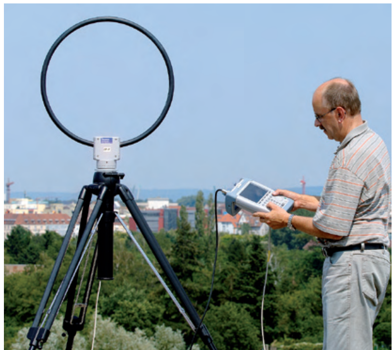
Messung von Funkwellen: Mit Hilfe einer Rahmenantenne werden die Signale von Rundfunksendern (Langwelle, Mittelwelle, Kurzwelle) erfasst. Quelle: LUBW
