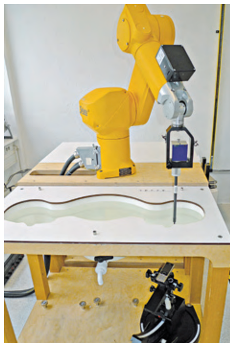
Messung des SAR-Werts eines Handys: Die Messsonde (schwarz) am Roboterarm (orange) ermittelt im flüssigkeitsgefüllten SAM-Phantom (weiß) den Ort der höchsten Feldstärke. Quelle: IMST GmbH
