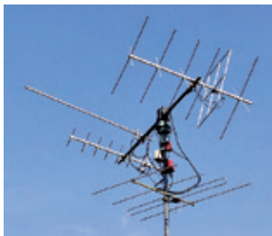
Amateurfunkantenne (X-Quad für 70-cm- und 2-m-Band, 1,7-GHz-Yagi und UKW-Antenne) Quelle: DK3WN
