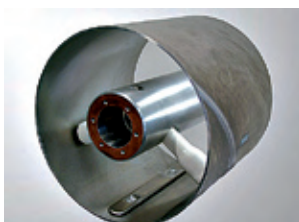
Gasisolierte Rohrleitung: Querschnitt durch ein GIL-Rohr der zweiten Generation. Der Stromführende Leiter befindet sich in der Mitte, außen das Mantelrohr mit einem Stützenpaar.
